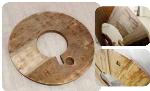
Прессующее кольцо Pressure ring of winding
